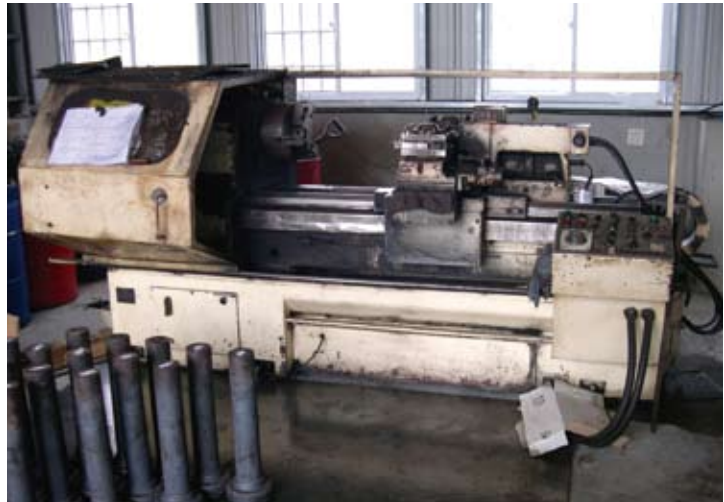
楊鐵工廠於1974年推出的國產第一部數值控制車床NCL1000
