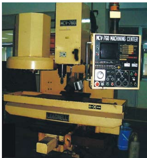
民國71年2月由台灣麗偉推出第一部國人獨立設計開發的CNC綜合加工中心機（MCV-760）。
