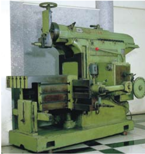
台灣最早的工作機械—牛頭刨床。這是民國43年（1954年）由台中精機推出的產品，先後製造5,000台，銷遍國內、東南亞、中南美等各地，堪稱台灣最早的工作機械。
