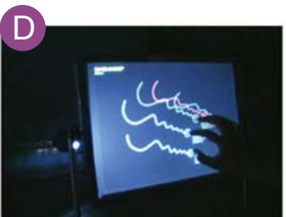
● 目前發展中的觸控技術，(A) Floating Touch Display技術，(B) Sixth-Sense技術，(C) G-Speak技術，(D) Frustrated Total Internal Reflection技術。(圖片來源：A： www.nict.go.jp/ ，B： www.media.mit.edu ，C： www.oblong.com/ ，D： http://mrl.nyu.edu/ )
