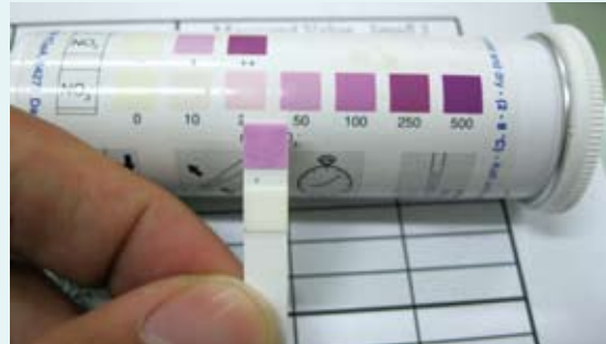
● 把試紙放入由蔬菜可以食用的部位所打成的汁液中，經過一分鐘之後，可以直接利用顏色的變化，以肉眼比對得知汁液中的硝酸鹽濃度，再以蔬菜及水的比例換算成蔬菜中的硝酸鹽含量。但由於每個人對於顏色的敏感度不同，判讀所得的數值也可能出現差異。
