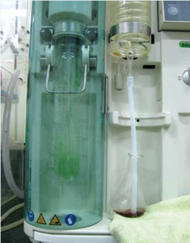
● 蒸餾法是傳統上用來檢測氮含量的方法，把汁液中的氮轉變成氨氣，氨氣經冷凝後會形成氨水，再以滴定的方法得知汁液中的硝酸鹽含量。
