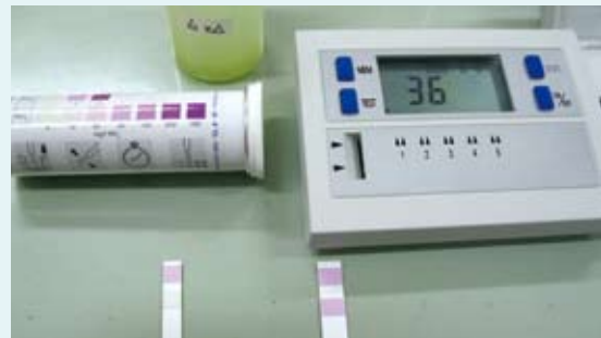
● 試紙除了可以用肉眼進行顏色比對得知蔬菜中的硝酸鹽含量外，把呈色之後的試紙放入儀器中判讀，可以增加數值的準確性。
