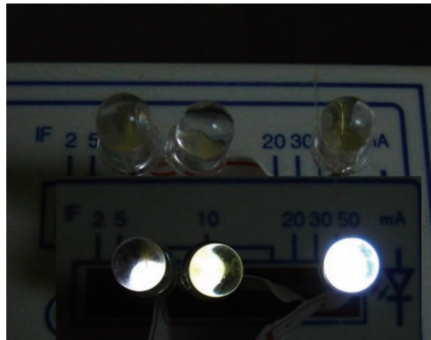
由左到右在電流逐漸升高下，LED 的發光情形。
