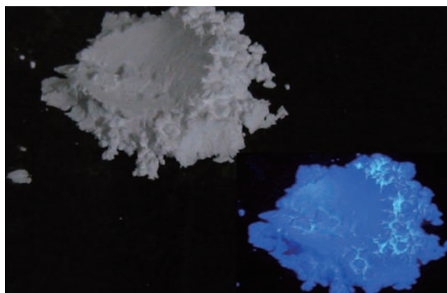
藍色螢光粉受紫外光激發後產生的藍光
