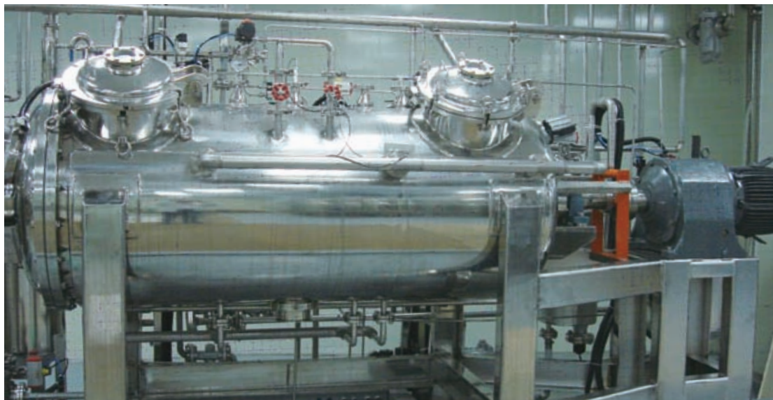
使用 1 噸固態發酵槽發酵生產紅麴
