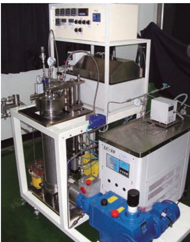
超臨界微奈米粉體成形設備 利用超臨界抗溶劑法能夠製造微奈米粒徑的粉體。
