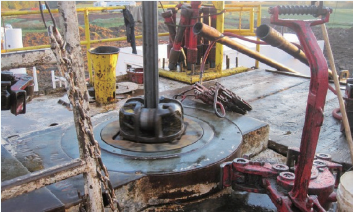
帶動鑽串旋轉鑽進的轉盤及方鑽桿（圖片來源： www.aed-corp.com ）
