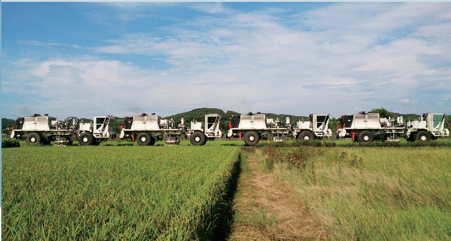
陸上的人工震源，4部振盪震源車同時進行振盪中。
