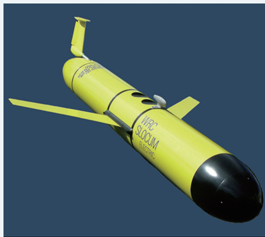
海洋中心的自主水下滑翔機（圖片來源：Teledyne 史洛坎水下滑翔機訓練手冊）
