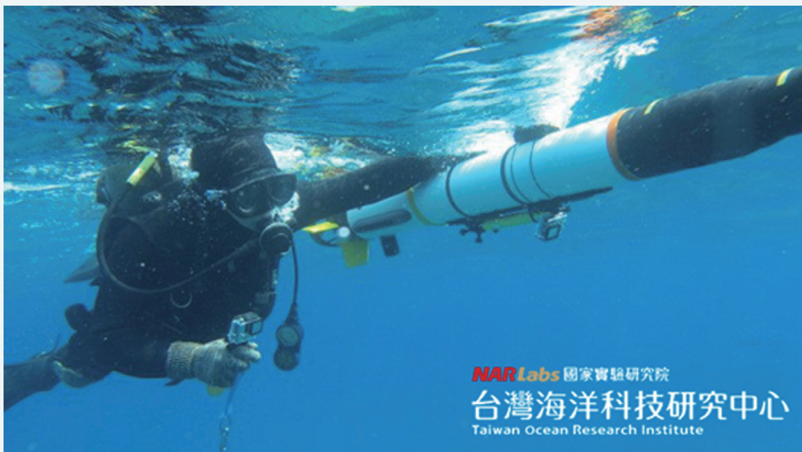
海洋中心的 Ocean Server IVER2 是國內海洋科學研究現役的自主式水下載具之一
