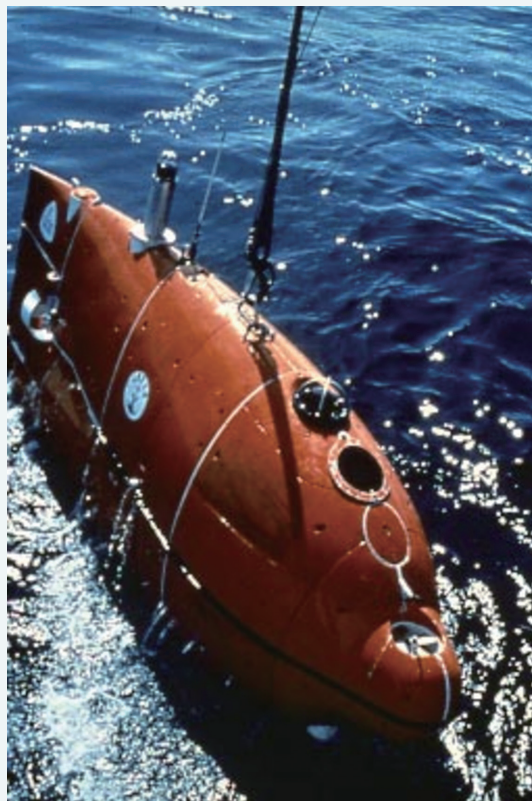
海洋研究用 AUV 鼻祖 EPAULARD (圖片來源： http://www.ifremer.fr/ )
