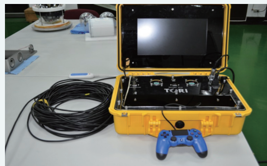
岸上監控系統控制箱
