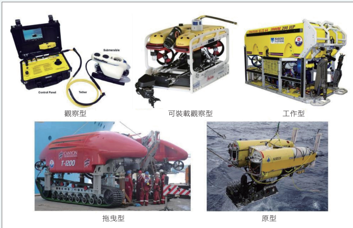
ROV的分類(圖片來源:VideoRay(左上)、SAAB Seaeye(中上)、Forum Energy Technologies(右上與左下)、WHOI(右下)網站)
