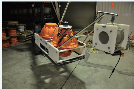
錨碇與主體結合後的吊掛姿態
