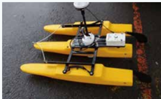
用於河川流量觀測的聲波都卜勒流速儀
