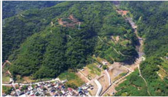
台東大鳥社區，莫拉克颱風所造成的土石流災害（左圖），以及災後，於溪流中上游建置攔砂壩及梳子壩攔阻土砂，保障下游的社區安全（右圖）。（圖片來源：行政院農業委員會水土保持局）
