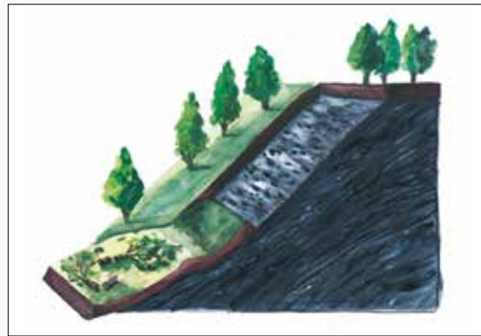
淺層崩塌示意圖（圖片來源：黏智硯繪製）
