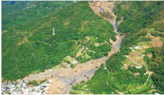
台東大鳥社區，莫拉克颱風所造成的土石流災害（左圖），以及災後，於溪流中上游建置攔砂壩及梳子壩攔阻土砂，保障下游的社區安全（右圖）。（圖片來源：行政院農業委員會水土保持局）
