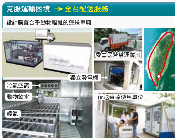
(左) 台東場改進分娩舍的設計與管理方式，移除限制母豬活動的分娩架，使母豬擁有更寬敞的哺乳空間，增進親子互動；(右) 台東場設計與購置動物運送車廂，並建立全國配送服務，車廂內配置獨立發電機、空調、暖氣、溫溼度記錄器與飲水管線，確保實驗豬能於合宜舒適的條件下運輸，以維護動物福祉。
