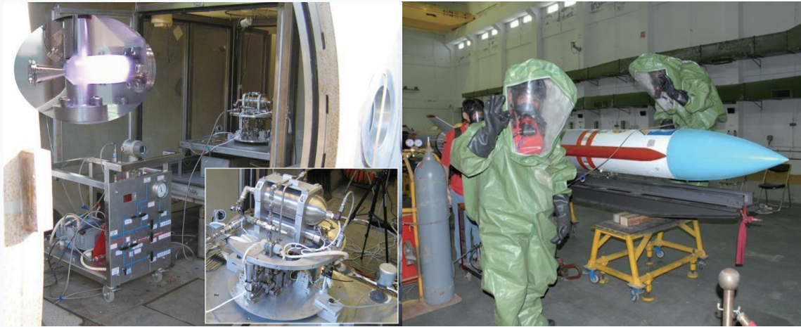
探空六號火箭聯胺推進器酬載計畫的執行，促使國內推進研究從實驗室走入系統工程，是國內衛星推進研究的重要里程碑。左圖是探六推進器酬載系統真空艙測試照片，右圖是探六火箭發射前聯胺推進器酬載推進劑灌注作業照片。
