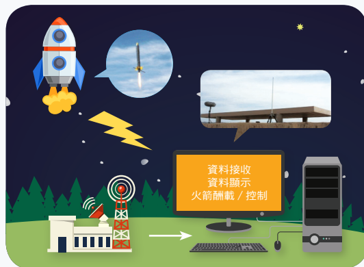
火箭與酬載的工程和科學資料經由無線通訊傳送至地面接收站，把訊號解調、資料解碼並即時顯示。
