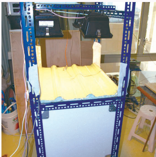
相變化材料應用於浪板夾層可有效阻隔熱能穿透鐵皮浪板
