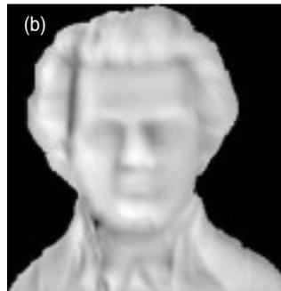
**光影重構** (a)重構前和 (b)重構後的結果；利用光線對物體表面所產生的反射與折射差異，由影像重構三維模型。（J. -W. Hsieh, 1995）
