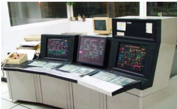
現代肥料生產微電腦控制系統（DCS）
