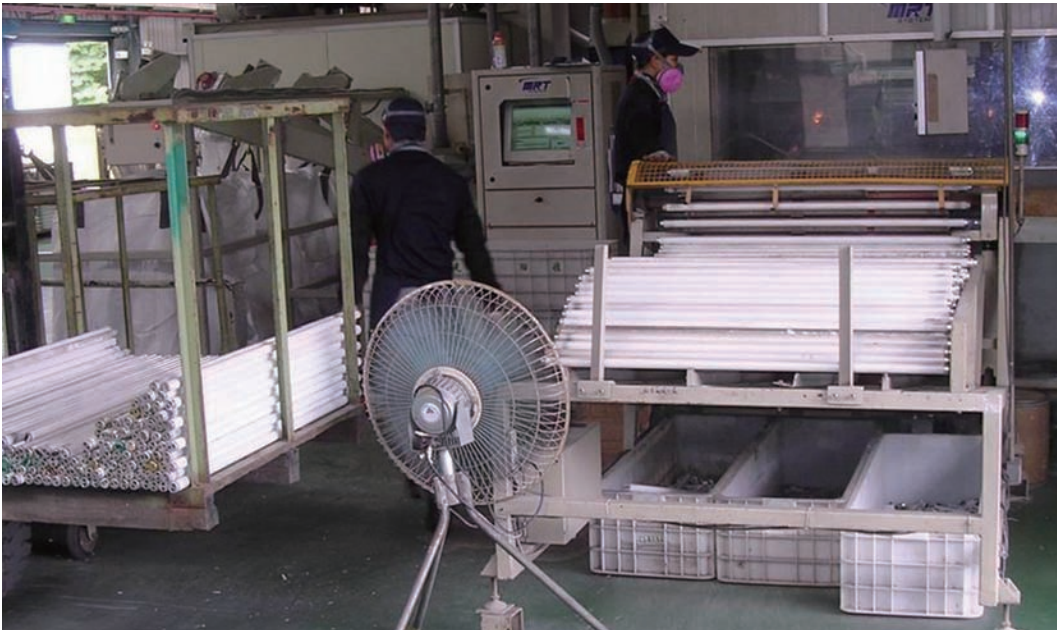
日光燈管回收廠。這台機器把燈管打破，回收汞、玻璃、燈絲、接頭的金屬及螢光粉。左邊的方形框架是運送燈管的推車。這台機器每天可以處理一百多車，每車大約裝 1,000 支燈管，能回收 10 公克水銀，大約是 8 支體溫計的用量。
