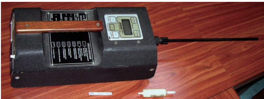
攜帶式的汞汽探測儀，利用金箔吸附了汞後電阻會增加的原理。
