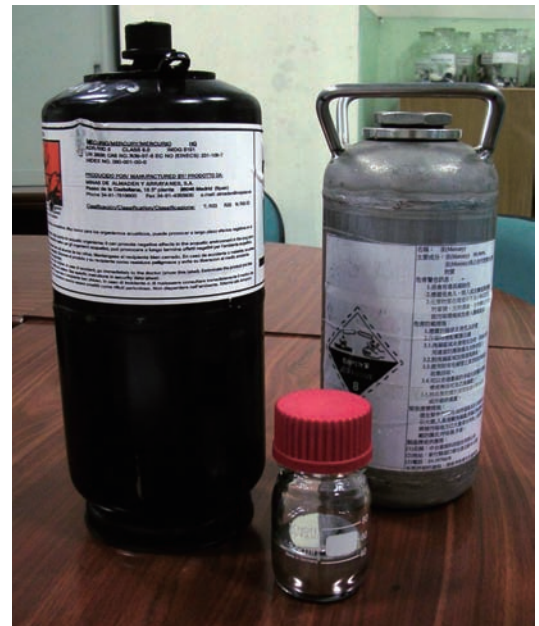
左邊是從西班牙進口的一瓶汞，重34.5公斤；右邊較小的瓶子是日光燈回收工廠用來裝回收蒸餾的高純度汞的。瓶子要用鋼做，因為鐵和汞不會在常溫形成汞齊。裝有少許汞的玻璃瓶容量100 ml，可做為比例尺。
