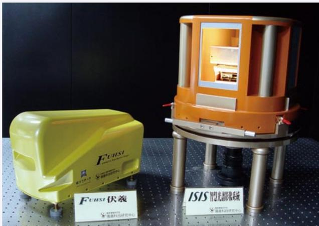
智慧光譜影像儀及伏羲高光譜儀：高光譜影像儀結合成像及光譜分光兩種技術，擁有成像及光譜解析功能，可應用於精準農業、水質監測及外來物種搜尋外，對於河域環保及生態濕地保育等方面亦有其功效，並可利用光譜資訊量得水果甜度。此外，這種光譜影像也可應用於材料檢驗、布料顏色快速品管及醫藥品管檢定，近來也應用於臨床腫瘤檢驗。
