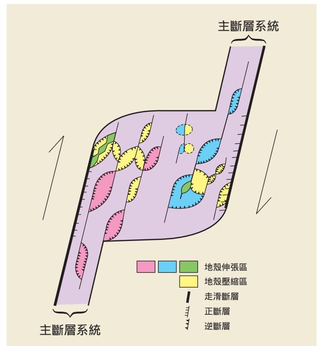
中國華北大尺度的地體構造圖（由那別列克、陳望平與葉洪於一九八七年所提出），整個中國華北是一個大尺度的雁形走滑構造系統，而華北盆地位於兩個相鄰的右移走滑主斷層之間，由兩個主斷層上的相互錯動而造成。這個模型解釋了為何唐山大地震雖在華北盆地內，但卻是一個走滑斷層。
