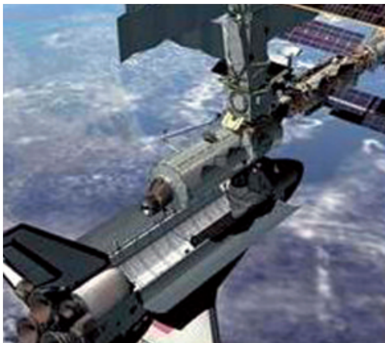
太空梭正在進行與國際太空站相連結的動作，物資及人員將由此連結進出太空站。
