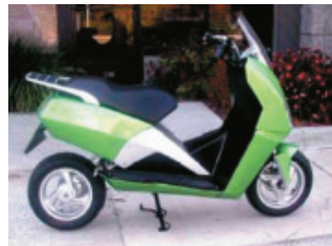
車體經過重新設計的燃料電池電動機車，電池組在座墊的下方，四支儲氫罐在前車殼架的內部。
