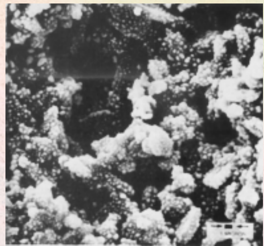
銀／氧化鋁觸媒的掃描式電子顯微鏡圖。此種觸媒可用於催化由乙烯和氧製備環氧乙烷的反應。
