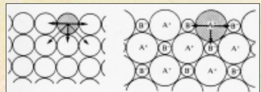
共價（左圖）與離子（右圖）固體表面能的示意圖。
