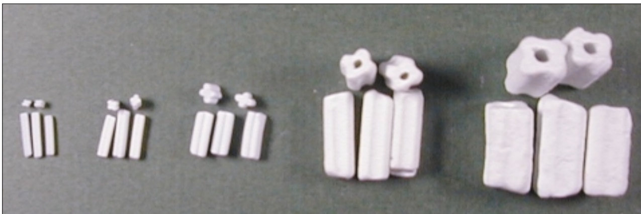
同形狀不同尺寸的重油加氫處理商業觸媒。截面直徑（由左至右）： 1/18 、 1/14 、 1/10 、 1/6 及 1/4 英寸。
