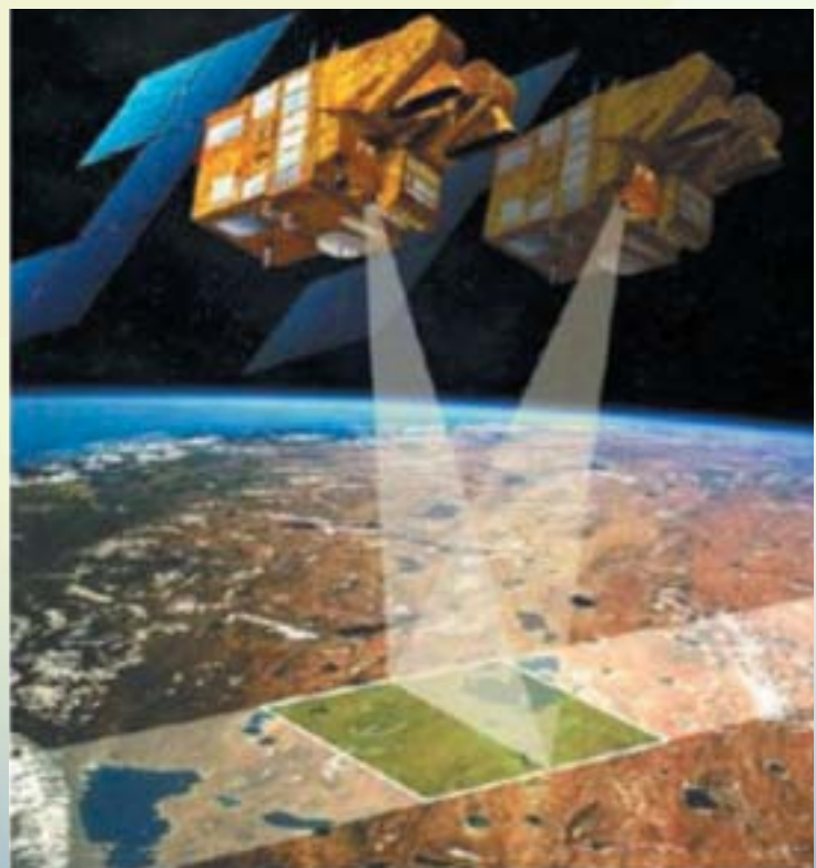
衛星遙測影像可以利用不同的角度拍攝立體像對，並可藉以製作數位化地形資料。
