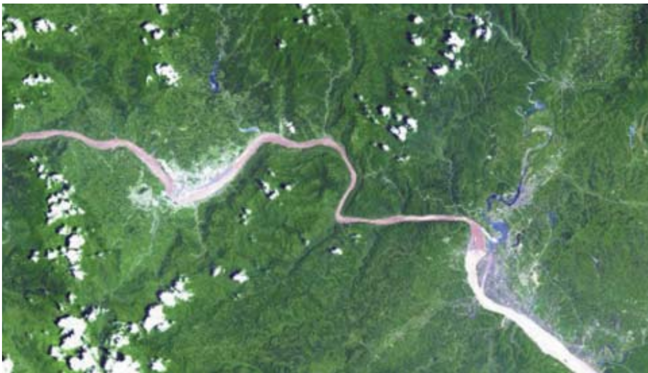
長江三峽大壩的ASTER衛星遙測影像 三峽大壩在圖的左側。在圖的中間，河流彎曲穿越群山的峽谷，就是位於三峽最東的西陵峽。峽谷地形非常明顯，包括河道寬度縮減、河流兩岸地勢高峻。從區域的地形來看，峽谷位置與區域岩石特性的分布有密切關係。影像顯示峽谷地區分布了許多堅硬、抗蝕性強的岩石，而且呈東北—西南走向。
