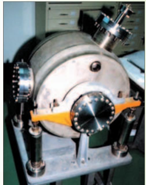
高頻共振腔 加速器的核心是一個高頻共振腔，電子或離子在裡面被電場加速。
