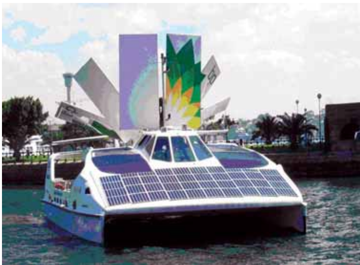
雙船體複合型太陽能風帆船上的 8 支帆，可垂直水平升降及左右旋轉，以迎接最佳的日照角度，使太陽能板維持最高的發電效果。
