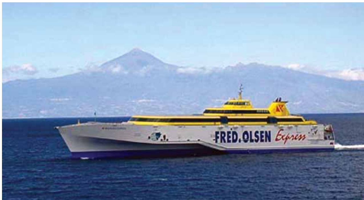
澳洲奧斯圖船廠所完成的超大高速三體客輪船，長126.7公尺，寬30.4公尺，吃水4公尺，馬力4×8.2百萬瓦。
