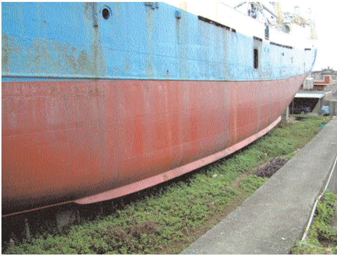
曾經前往南極海域捕蝦的「海功號」，船側和船底相接處裝有減搖鰭。
