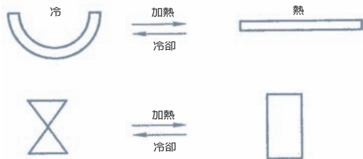
雙向記憶合金加熱和冷卻過程中形狀的變化
