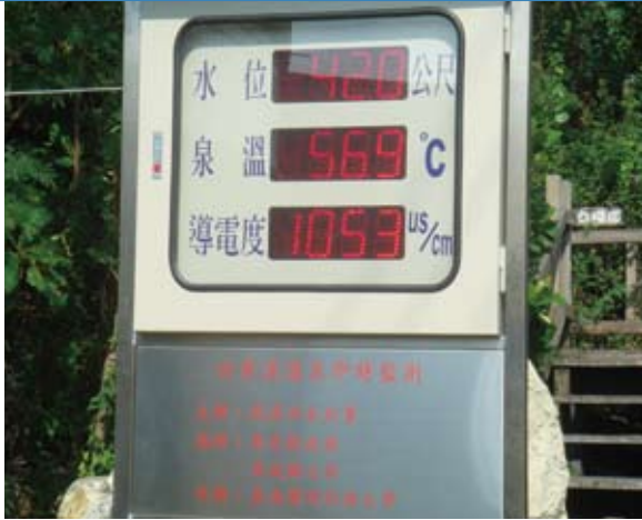
因應不同的溫泉產出型態，設置不同的監測站。照片中是屏東縣四重溪溫泉的監測站，可即時顯示水位、水溫及導電度。溫泉水的導電度可反應出溫泉中的礦物質濃度。
