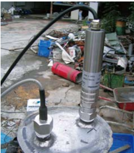
高溫高壓井的水壓與水溫監測儀器
