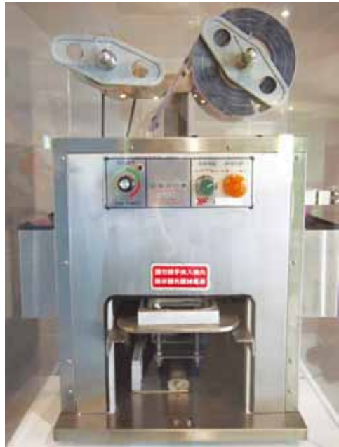
第一部手動的封口機，重量 60 公斤，體積相當龐大。
