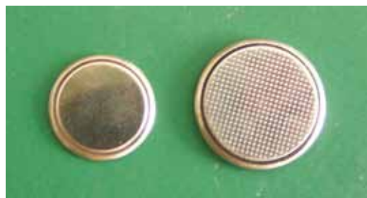
鈕扣型鋰電池的規格已標準化，通用的標示是 CR-xxxx (數字)，前兩數字表示直徑，後兩數字表示高度，單位都是 mm，如 CR-1220 鋰電池直徑是 12 mm，高度 2.0 mm。
