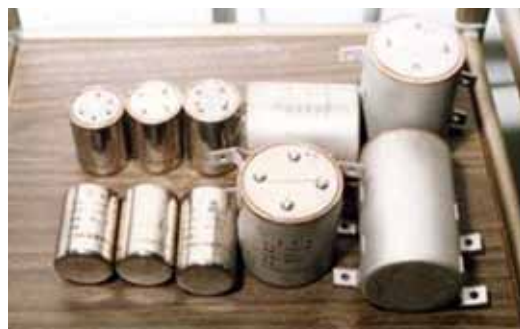
圓柱型熱電池，多個單元電池串並聯後，可做為武器系統的大電源。(圖片來源：中山科學研究院)
