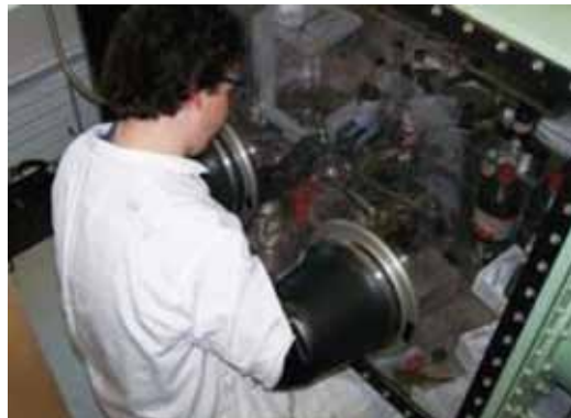
乾燥箱的外框是不銹鋼材質，加上除溼乾燥設備，相對溼度可維持在 1%。
