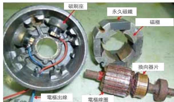
永磁式直流有刷馬達結構的照片
