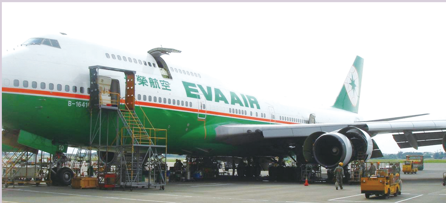
執行 A 級檢查的飛機，工作梯架、平台與各式測試裝備已在機邊，維修人員準備執行勤務。
