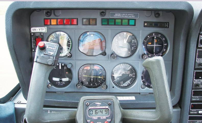
TB-10 Tobago 飛機左座（即學員所坐位置）儀表板與操控桿的示意圖。在飛行中，飛行員要手、眼、腳協調，眼睛要不斷「掃描」各個儀表的變化，包括姿態、速度、高度、航向、垂直速度等，再配合手上的操縱桿和油門以及腳上的舵，把飛機操作在目標範圍內。第一次飛行的人往往容易盯著一個儀表而忽略了其他部分，經過教練不斷的提醒也難以負荷駕駛艙內的所有工作。
