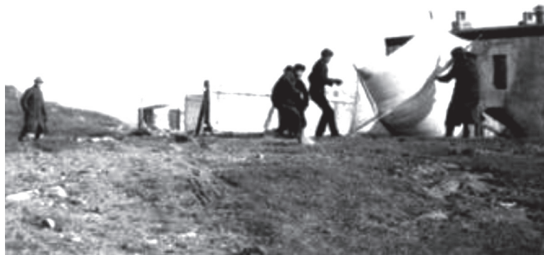
1901 年 12 月，馬可尼及巴傑特（Paget）、肯普（George Kemp）兩位助手在加拿大紐芬蘭的聖約翰市海邊，把做為天線用的導線繫在風箏和氣球上試放。
