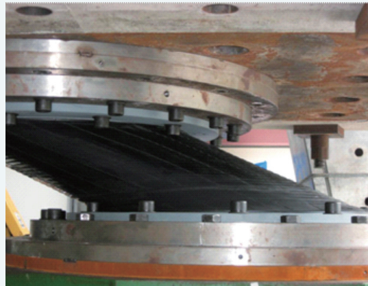
正在進行試驗中的橡膠類隔震支承
