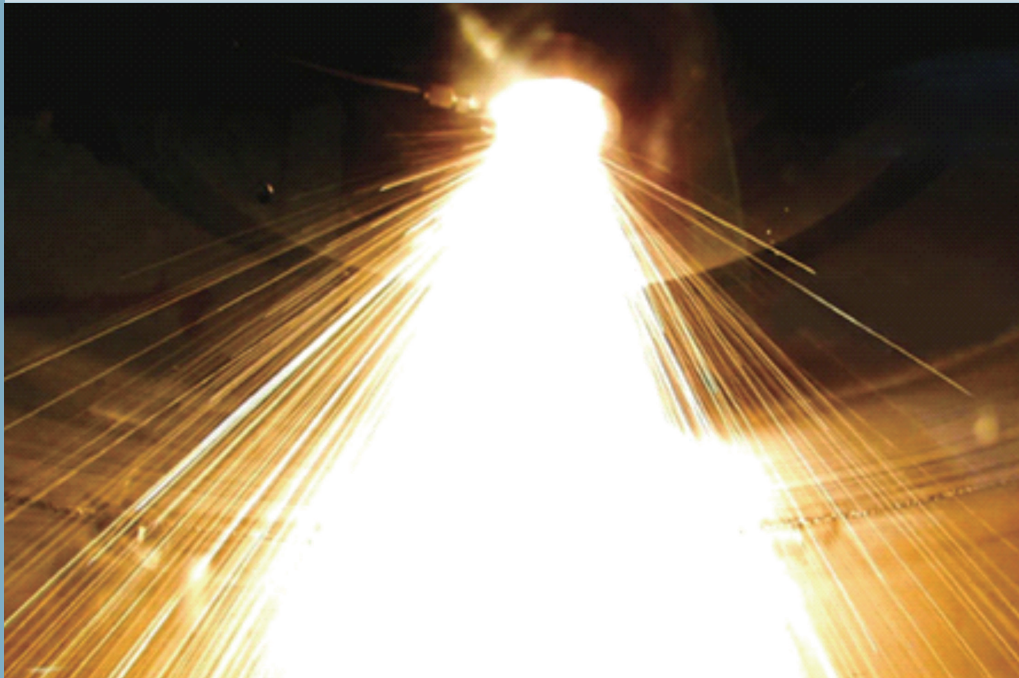
高速氣體衝擊金屬熔湯產生高溫霧狀的金屬液滴，冷卻後形成微細的金屬粉末。
