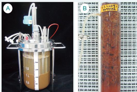
利用生物反應器生產紫杉醇：(A) 細胞培養—具有攪拌葉片循環營養液的攪拌式生物反應器；(B) 毛狀根培養—利用氣體使營養液循環的氣舉式生物反應器。
