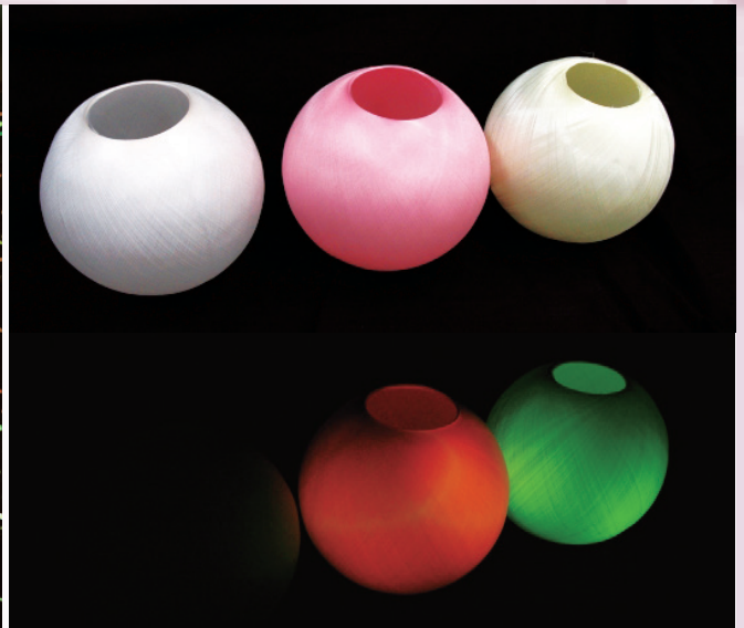
螢光蠶絲燈具；左側燈具以普通蠶絲製作，中間及右側是以紅色及綠螢光蠶絲製作的絲燈具；上圖以普通白光照明，下圖則以 LED 照明。（圖片來源：日本獨立行政法人農業生物資源研究所）
