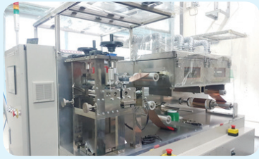
自動滾輪塗布熱風乾燥機 進行極片的漿料塗布、烘乾及捲收
