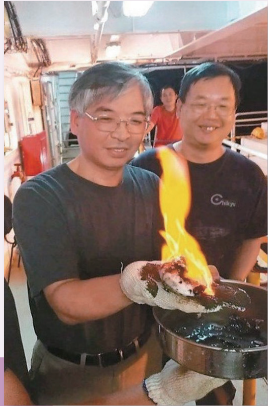
科技部第2期能源國家型科技計畫中的「地熱與天然氣水合物」計畫，邀請法國海洋研究船瑪麗杜凡號來台執行海域岩心採樣工作。照片中的研究人員以打火機點燃正在緩緩解離中的天然氣水合物（可燃冰）。（圖片來源：科技部）
