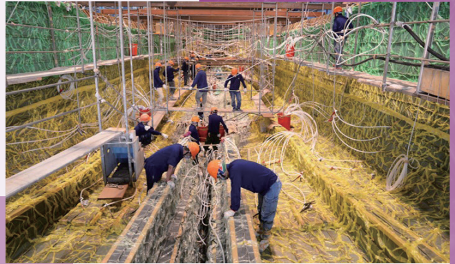
製造大型玻璃纖維強化塑膠遊艇（圖片來源：嘉鴻遊艇公司）
