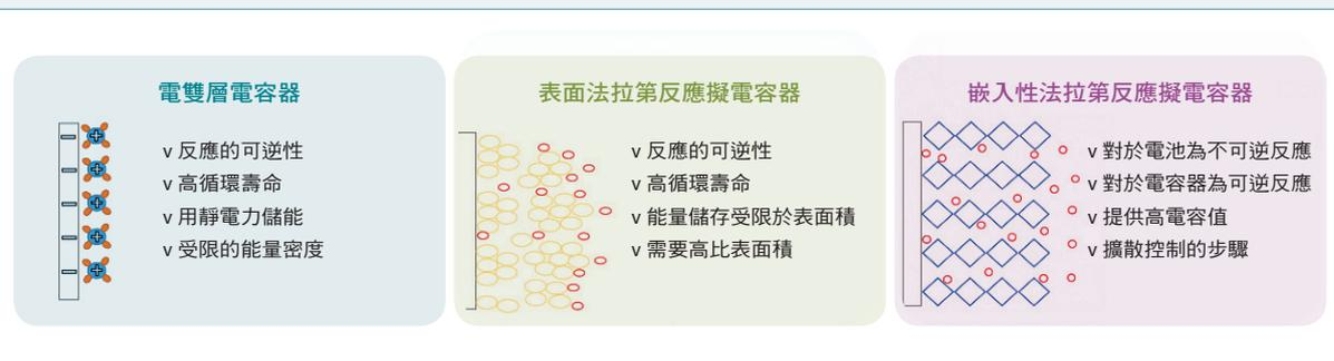
電雙層電容器及擬電容器的儲電機制
