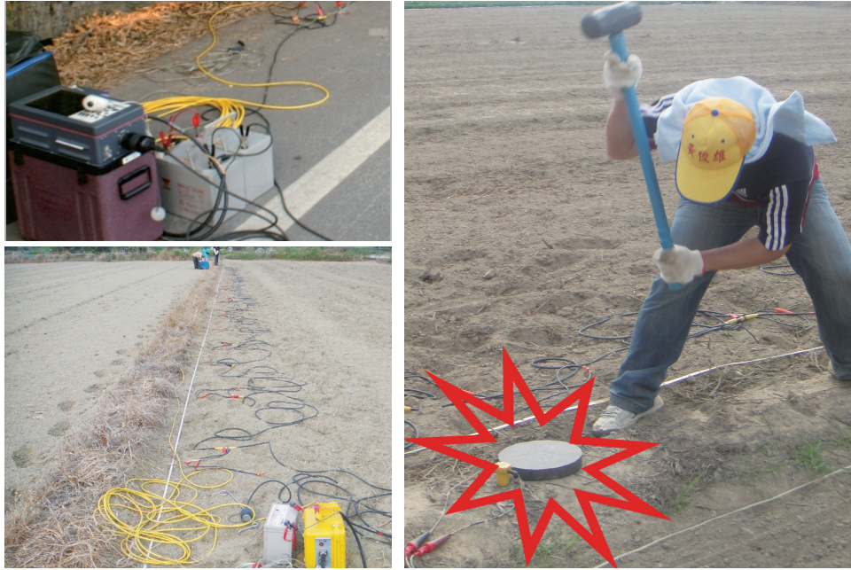
震測儀、測線布線方式，以及人工利用 16 磅大榔頭敲擊的方式產生震源。
