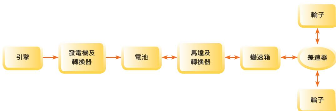
**串聯混合動力汽車** 由一具功率僅供滿足行進時平均功率的內燃機（也可以是外燃機）作為發電機發電，為電池充電及供電給電動機，車上唯一推動車輪的是電動機。這種設計可以增加電池行走里數，因此稱為增程型電動系統，而其構造上動力輸出的流程完全是一直線，又稱串聯式油電混合系統。
