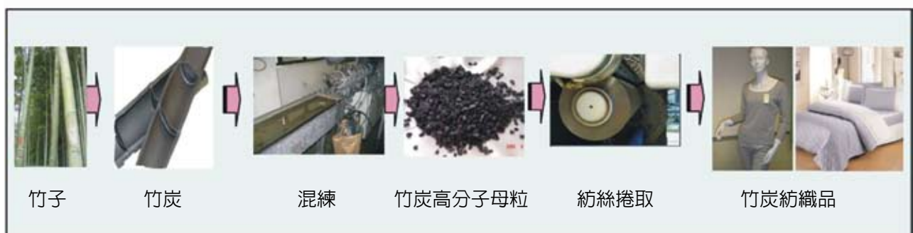
台灣盛產竹子，把竹炭粉粒混入合成纖維中，可製得具有特殊性能（如保溫、抗菌）含竹炭成分的化學纖維紡織品。（圖片來源：紡織綜合所）
