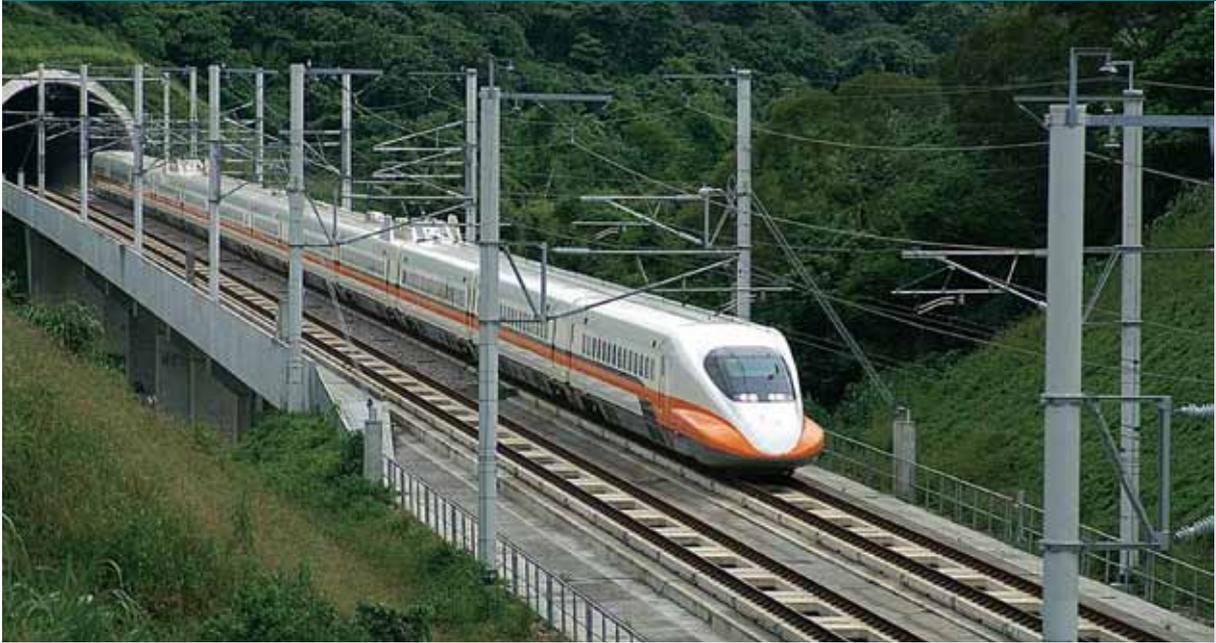
台灣高鐵 700T 列車。700T 主要由新幹線 700 型列車修改，兩者外形較顯著不同處在車頭形設計，新幹線 700 型車頭成鴨嘴狀，較長較扁，主要是為了避免高速駛出截面積較小的隧道時所產生的音爆現象。由於台灣高鐵土木規格傾向歐洲系統，因此隧道體較大，台灣高鐵 700T 就無須採鴨嘴形設計，其他土木規格如兩股軌道間距離等，都較新幹線的設計寬。（圖片來源：Wikipedia，屬公有領域合理使用）
