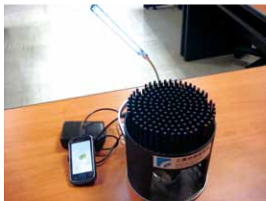
擷取環境能量的熱電發電應用：（上）體溫發電手表、（下）野外求生發電烤爐。
